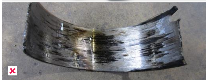
Scanalature profonde nel supporto motore dovute a particelle nel circuito dell'olio.
